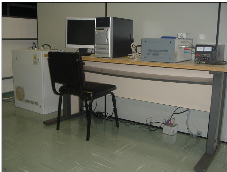
Figura 3- Fonte de alimentação da lâmpada e sistema de medição do simulador solar.
