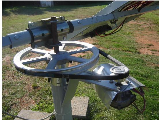
Figura 4 – Polias, braço horizontal e motor impulsor.
