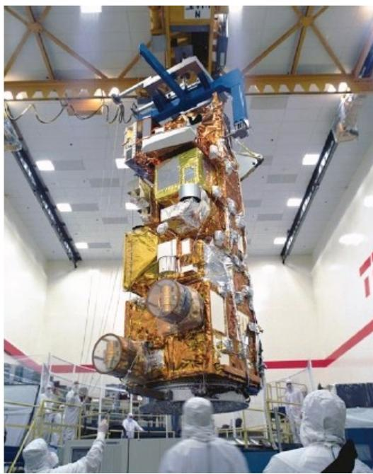
Figura 2 - Foto do satélite AQUA na fase de preparação para o lançamento. Os dois instrumentos CERES são visíveis próximos da base do satélite e estão com a estrutura de proteção. O sensor HSB é visível acima do instrumento CERES à direita. O AIRS está posicionado logo à esquerda. Acima do HSB, pode ser visto o sensor AMSU. O instrumento MODIS está localizado no topo à esquerda. Fonte: Parkinson, C. L. 2003.
