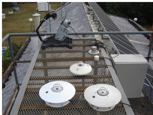
Figura 6 - Fotografia da plataforma de medidas de radiação solar do Labsol, UFRGS. Além dos piranômetros é visto um espectrorradiômetro com anel de sombra rotativo.
