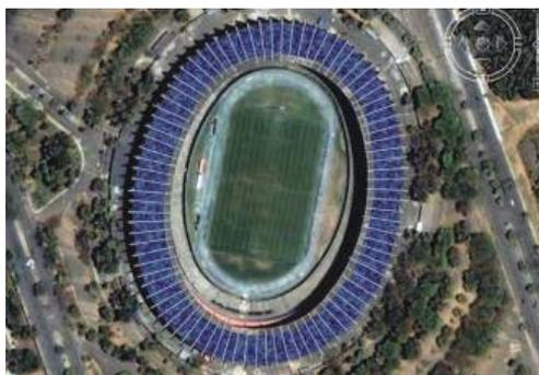
Figura 1 – Imagem aérea do Mineirão com a simulação da integração fotovoltaica na cobertura existente e sem sombra.
