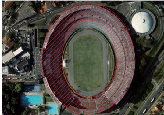
Figura 9 – Imagem da cobertura do Fonte Nova com a área para integração dos módulos fotovoltaicos.
