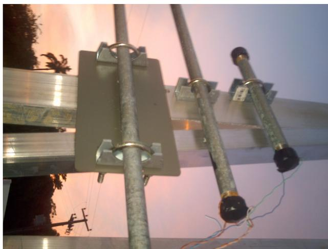
Figura 4 – Suporte dos tubos do sensor instalado no painel do rastreador.
