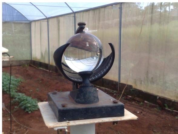
Figura 2- Heliógrafo instalado no interior da estufa
