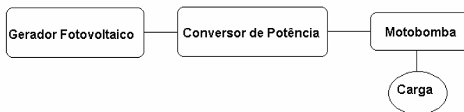
Figura 1 – Diagrama em blocos do sistema ensaiado
