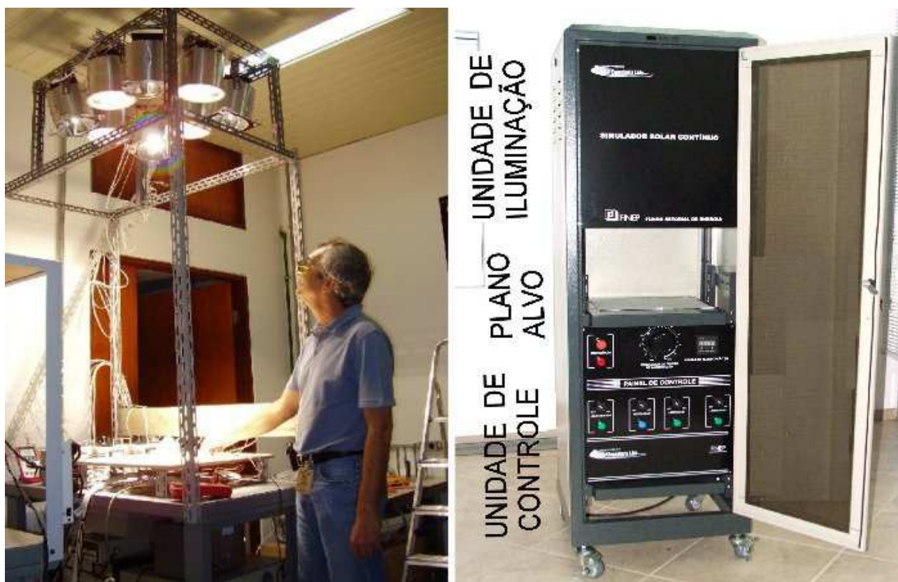
Figura 1- Protótipo de laboratório do simulador solar SOLSIM versus equipamento comercializável.
