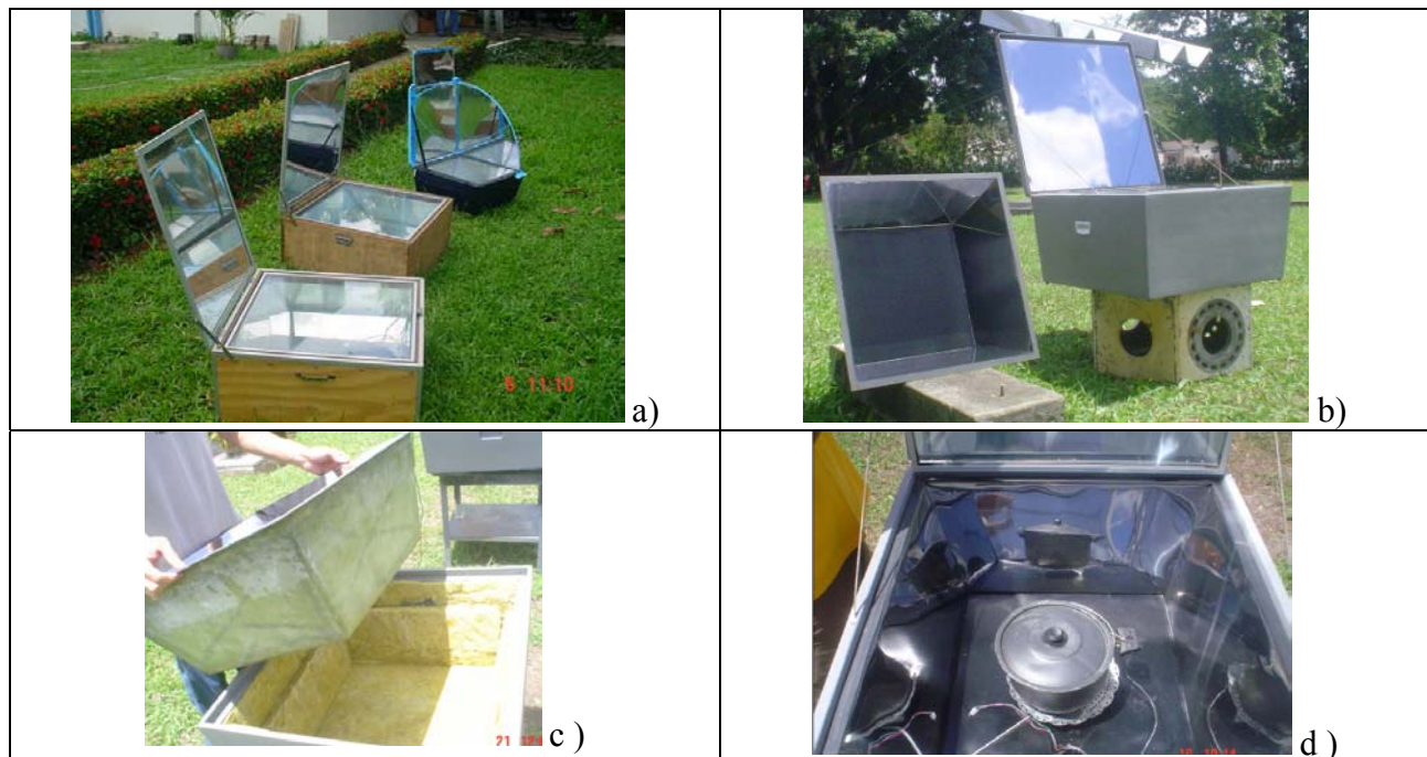
Figura 1- Ilustrações de fogões solares: a) primeiras unidades (FAE) em madeira, no fundo vista do exemplar, modelo comercial português; b) fogão exemplar teste (FAE), detalhe da câmara interna a esquerda; c) montagem do isolamento em fibra de rocha, d) exemplar em teste.
