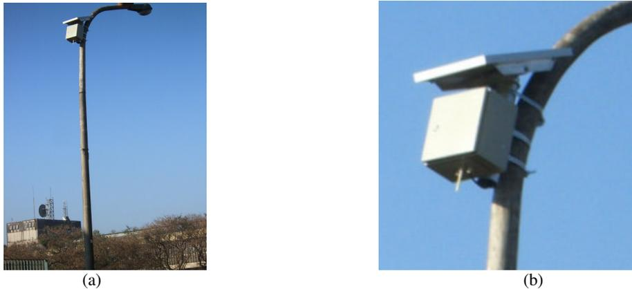
Figura 11 – (a) Protótipo SACM instalado em poste de iluminação a 6 metros de altura (b) Protótipo SACM.
