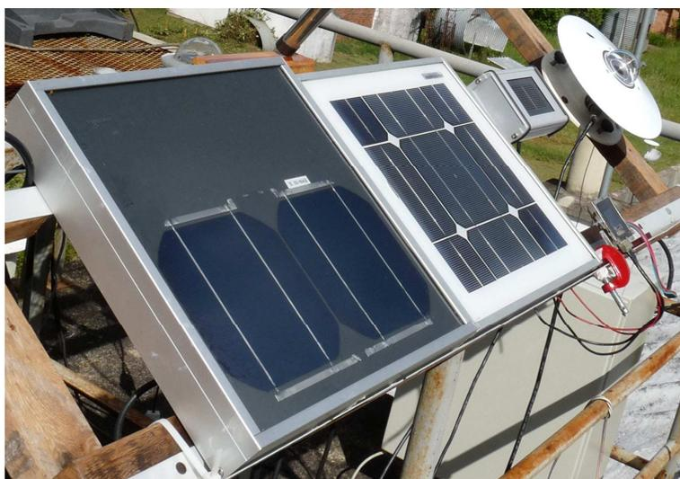
Figura 1 – Sensores de irradiância solar utilizados neste trabalho. Da esquerda para a direita: célula BP Solar, célula Isotón, célula compensada (acima), célula PS004 (abaixo) e piranômetro PSP Eppley.
