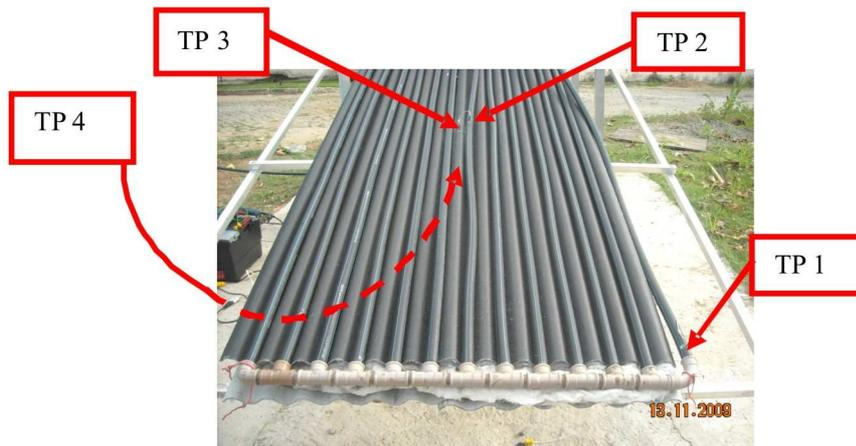
Figura 9. Detalhes da instalação dos termopares
