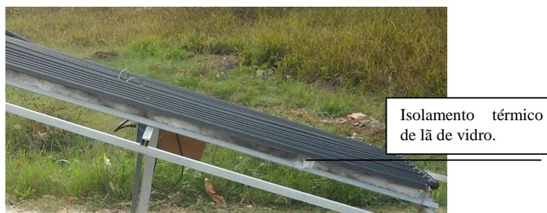
Figura 2. Detalhes do isolamento térmico do coletor.
