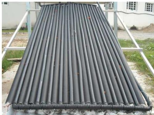
Figura 7. Detalhe das conexões de PVC pintadas de preto fosco.
