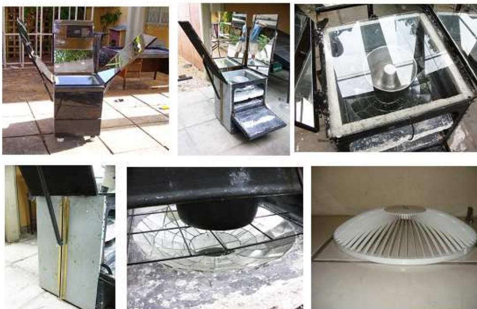
Figura 2. Vista da parábola refletora, da tampa de ventilador usada para sua construção e do absorvedor.
