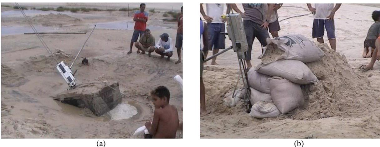
Figura 6 - (a) Base pivotando; (b) Solução para aumentar o peso da base.
