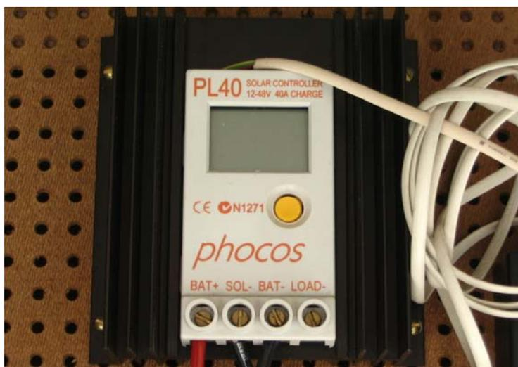
Figura 5: Controlador de carga, modelo PL 40 – Fabricante Phocos.
