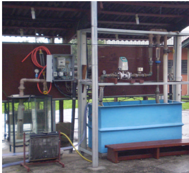
Figura 2: Foto da bancada de ensaios e trocador de calor.
