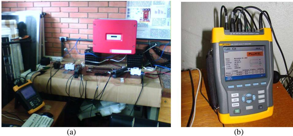
Figura 2 – (a) Bancada de ensaios e (b) analisador de potência *FLUKE 434*.
