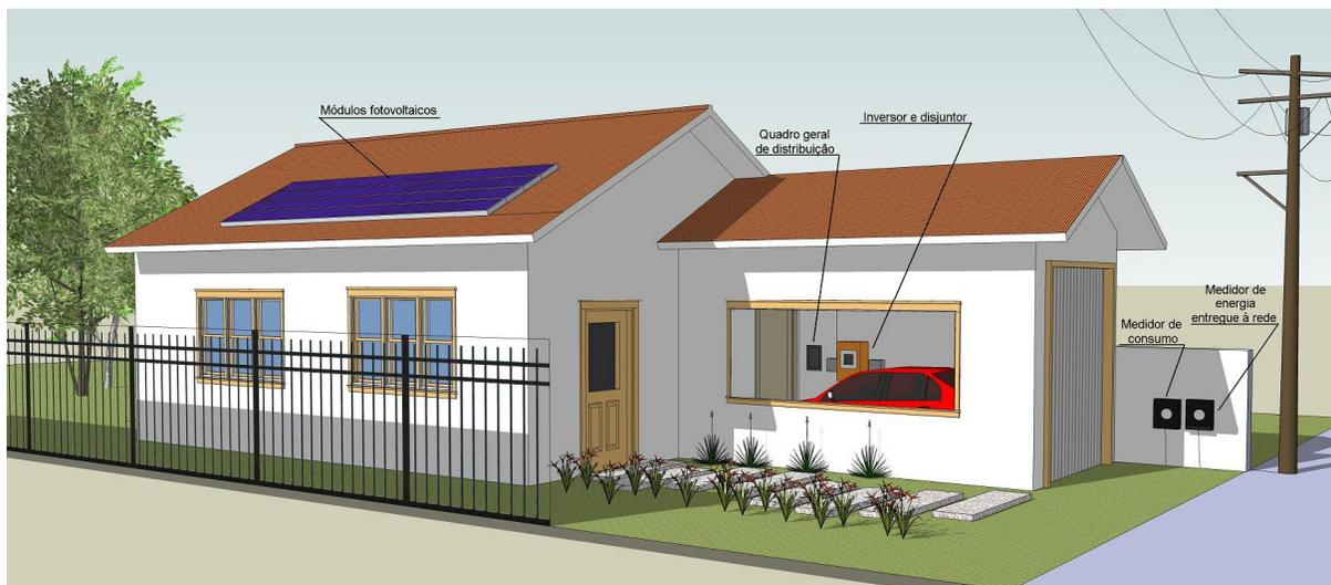
Figura 4 – Proposta de integração do kit e localização dos equipamentos utilizando a tecnologia de filmes finos.
