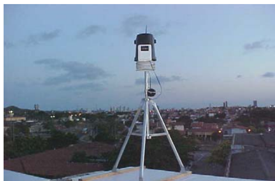
Fig. 17 – Mini-estação climatológica (a ser instalada no teto do LTC – UFRN).
