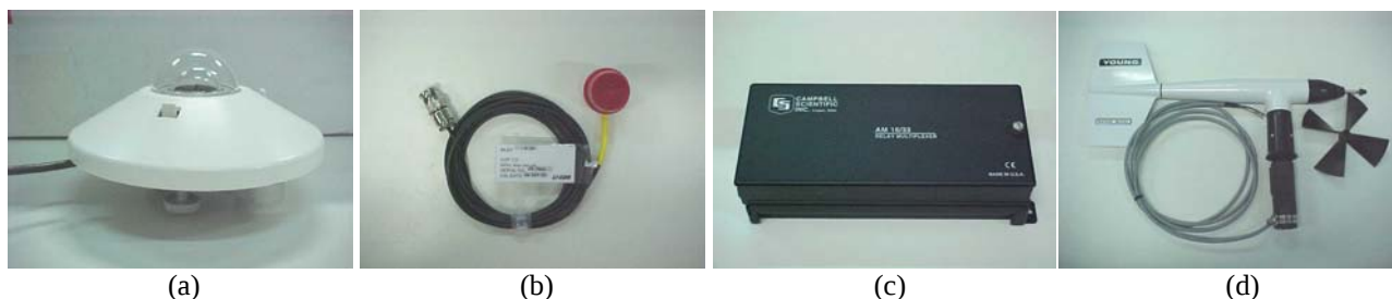
Fig. 7 – Componentes da cadeia de medição: (a) sensor de radiação; (b) sensor de iluminação; (c) multiplexador de sinais; (d) medidor de vento.
