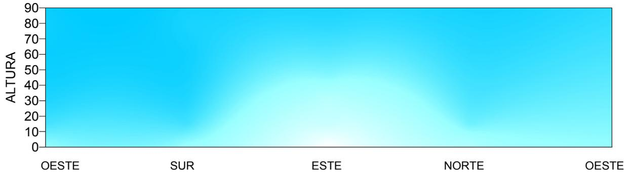
Figura 3. Gráfica de distribución de radiación difusa para Salta, utilizando proyección cilíndrica.
