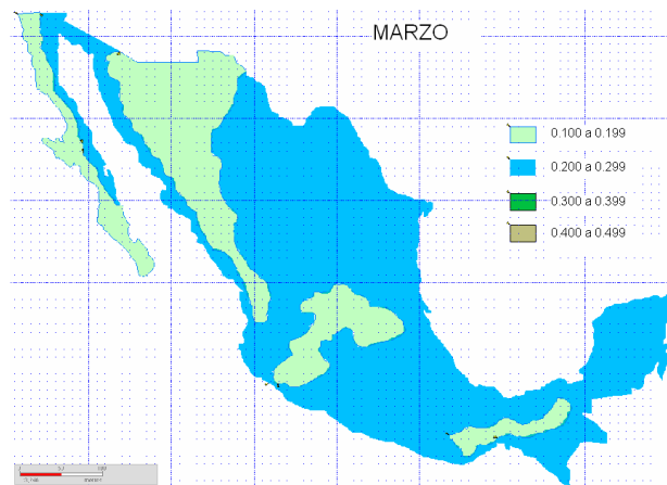
Fig. 3. Factores de ahorro de aire acondicionado para marzo
