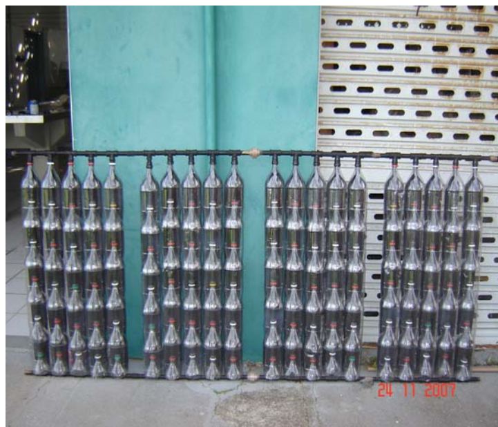
Figura 6 – Coletor solar com materiais recicláveis – 100 garrafas PET (quatro módulos)
