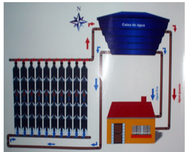
Figura 2 – Coletor solar por termosifão com um reservatório de água.
