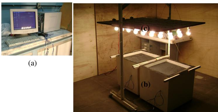
Figura 06. Aparato experimental completo: sistema de aquisição de dados (a), câmaras de ensaio de desempenho térmico de coberturas (b) e fonte de radiação térmica artificial (c).
