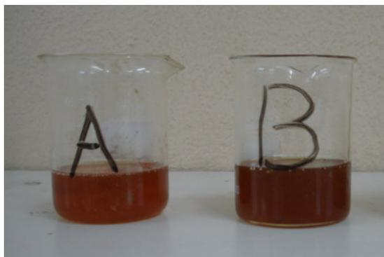
Figura 02. Componentes da resina expansiva de poliuretano derivado do óleo de mamona
