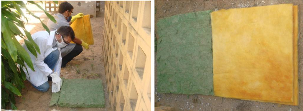
Figura 03. Preparação e placas de Lã de Rocha (verde) e Lã de vidro (Amarela)
