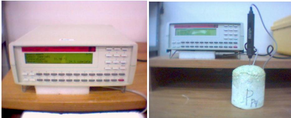
Figura 05. Quick-line: medidor das propriedades: condutividade, difusividade e capacidade calorífica
