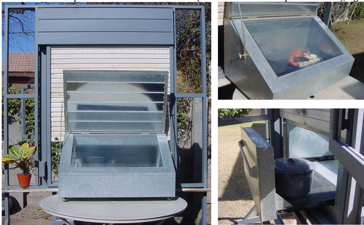
Figura 3 - Funcionamiento experimental exterior e interior del Horno Solar de Ventana tipo caja
