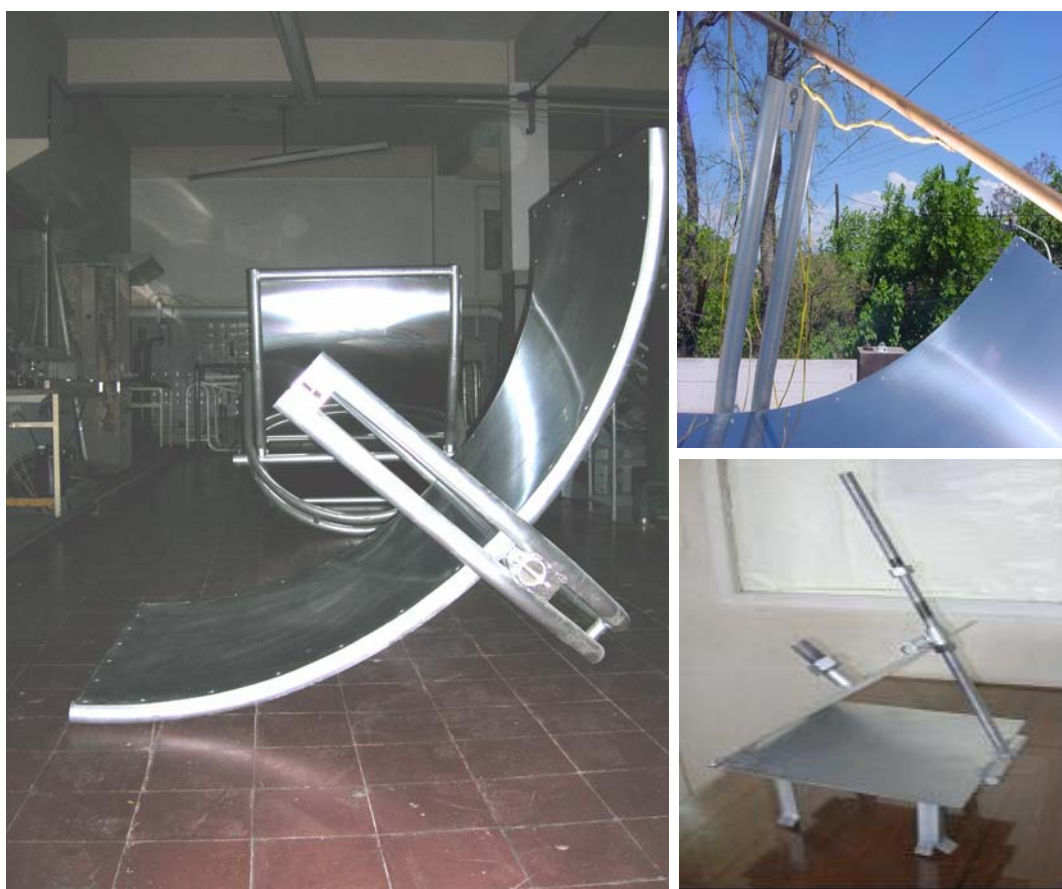
Figura 6 – Vistas de las características físico-técnicas del CPL, del absorbedor con los sensores durante la campaña experimental 1 y del sistema de posicionamiento solar.
