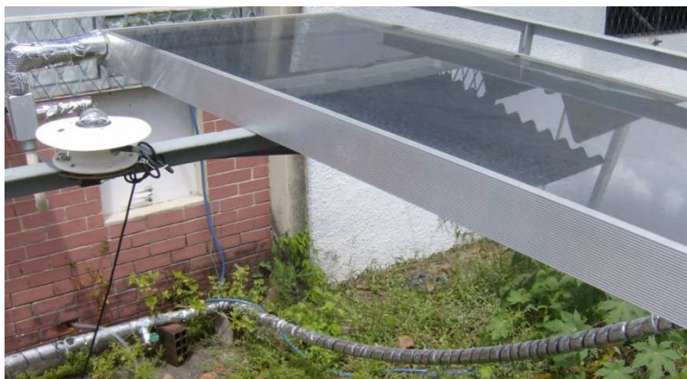
Figura 1 – Detalhe do coletor solar plano e radiômetro usados nos ensaios
