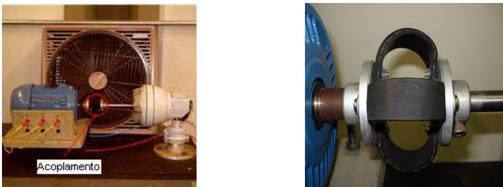
Figura 4— (a) Motor de 1 cv acoplado ao alternador do aerogerador na bancada (b) Detalhe do acoplamento
