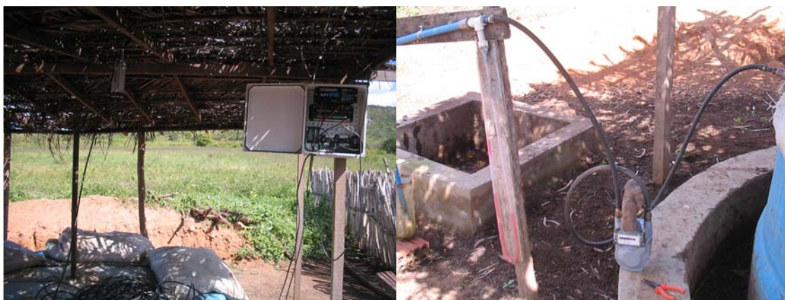
Figura 6: Sonda ultrasônica, sistema de aquisição de dados e medidor de vazão.
