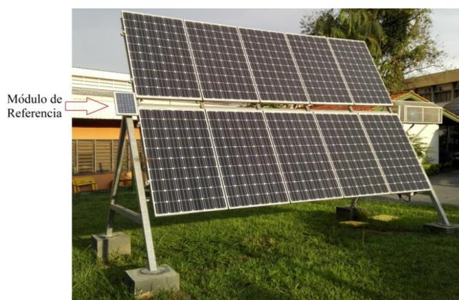
Figura 2 - Protótipo do seguidor solar de um eixo horizontal.
