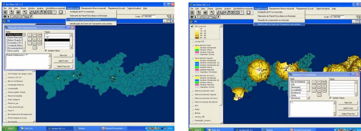
Figura 7 – Funcionalidades local do SIGA-SOL, Gestão FV, (a) situação operacional dos componentes dos sistemas FV instalados em Pernambuco e (b) os centros de manutenção mais próximos
