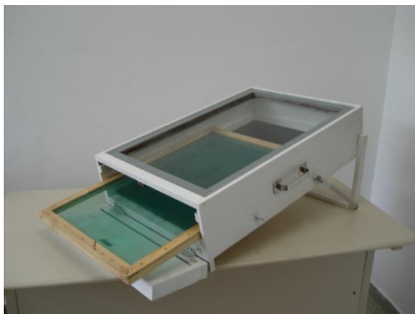
Figura 1. Secador solar portátil para desidratação de frutas.
