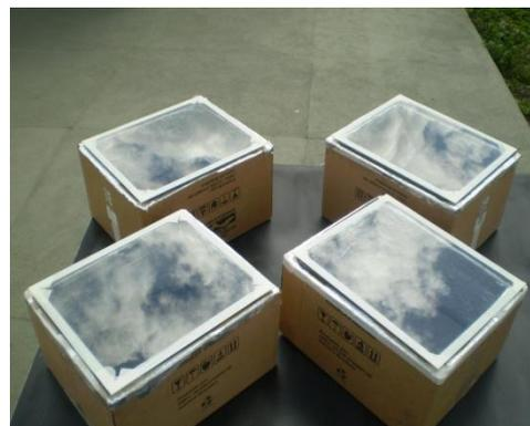
Figura 4: Fogões solares tipo caixa
