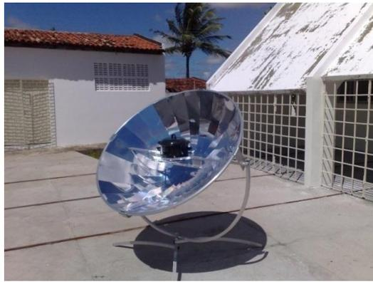
Figura 2: Fogão solar tipo parabólico
