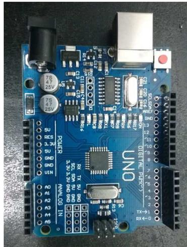
Figura 8 – Placa Arduino com ATMEL MEGA 328P.
