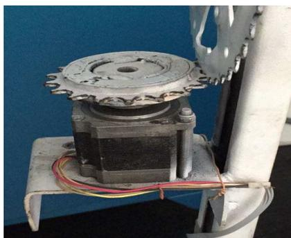
Figura 6 – Motor de passo unipolar 6 fios.
