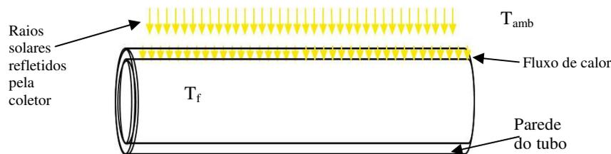
Figura 2- Condução de calor através da parede do tubo.
