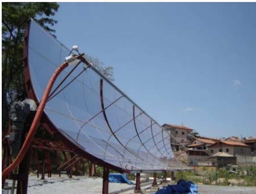
Figura 5 - Linha com cinco Coletores de Concentração Solar -Usina Térmica- CEFET-MG
