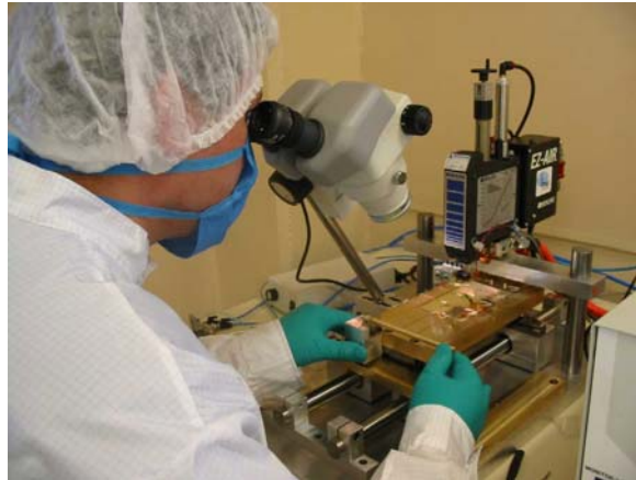
Figura 2. Sistema de soldadura mediante electrodos paralelos.
