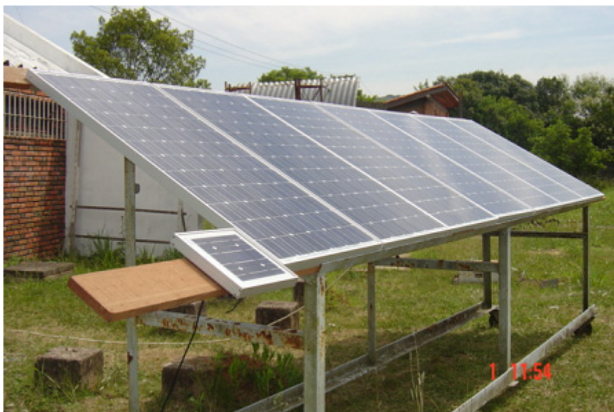
Figura 2: Módulos fotovoltaicos e célula de referência durante o ensaio.
