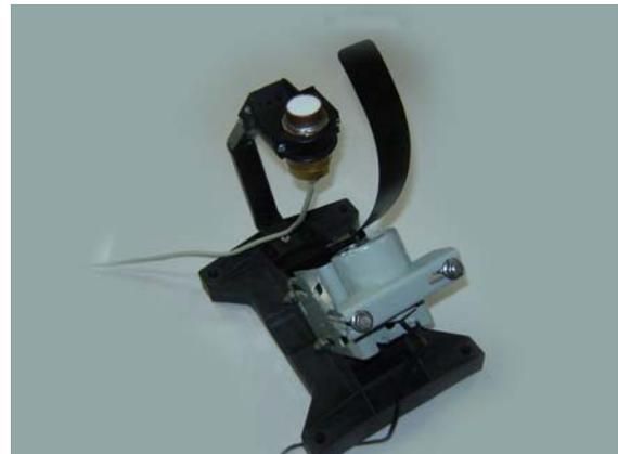
Figura 1 - Diagrama e foto do radiômetro espectral. Observa-se a unidade óptica com o difusor de *teflon* no centro e o anel de sombra rotativo comandado por um motor e caixa de redução.
