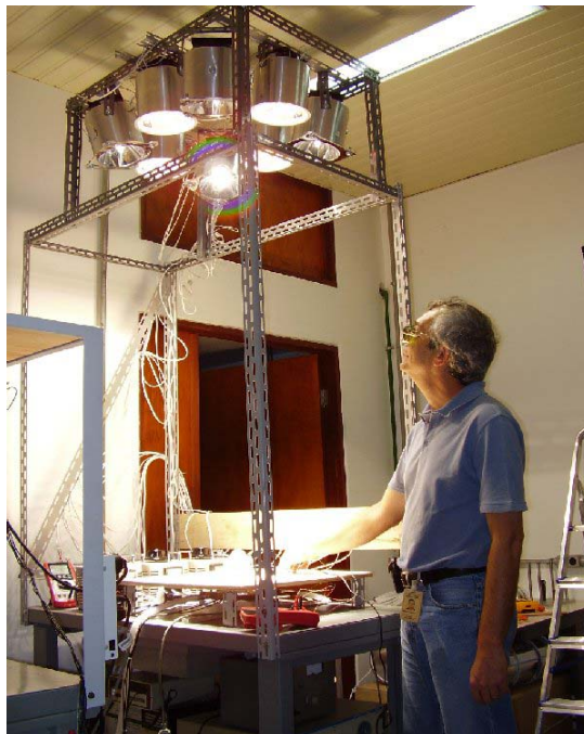
Figura 8 – Medida experimental da uniformidade do simulador solar de baixo custo produzido no Laboratório Associado de Sensores e Materiais do INPE de São José dos Campos.
