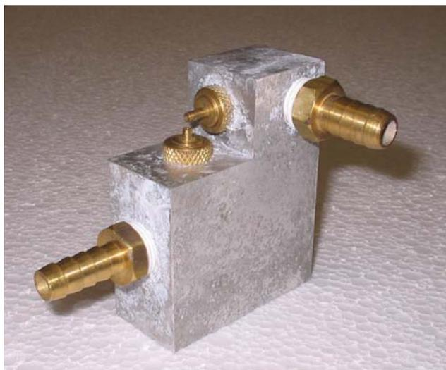
Figura 4 – Bico Pulverizador (lateral), IEE/USP
