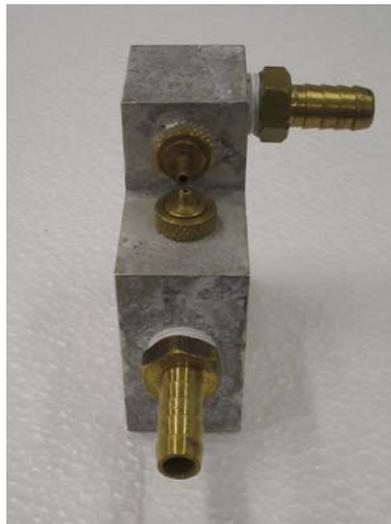
Figura 3 – Bico Pulverizador (frontal), IEE/USP
