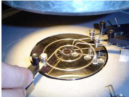
Figura 7 – Ponteiras usadas para o contato elétrico na célula solar.
