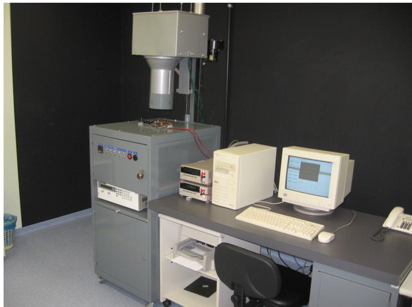
Figura 10 – Sistema completo desenvolvido para caracterização elétrica de células solares, denominado AD100.
