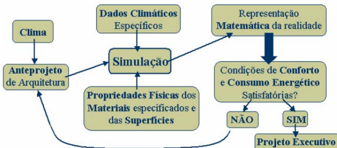
Figura 3: Esboço da fase de inserção da Simulação no desenvolvimento do projeto arquitetônico para verificação do conforto.
