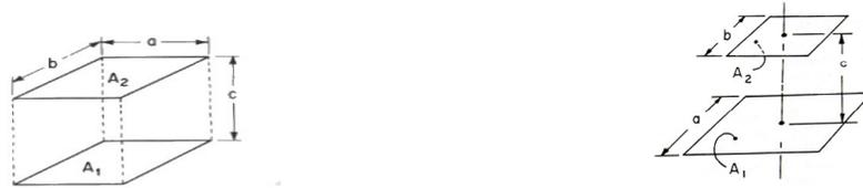
(a) Esquema de placas paralelas e iguais. (b) Esquema de placas quadradas tamanhos diferentes paralelas e concêntricas.
