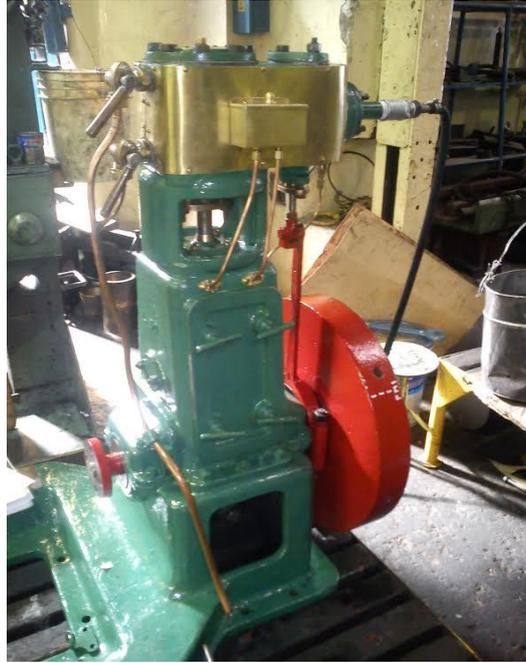
Figura 1- Vista externa del motor de vapor reciprocante.
