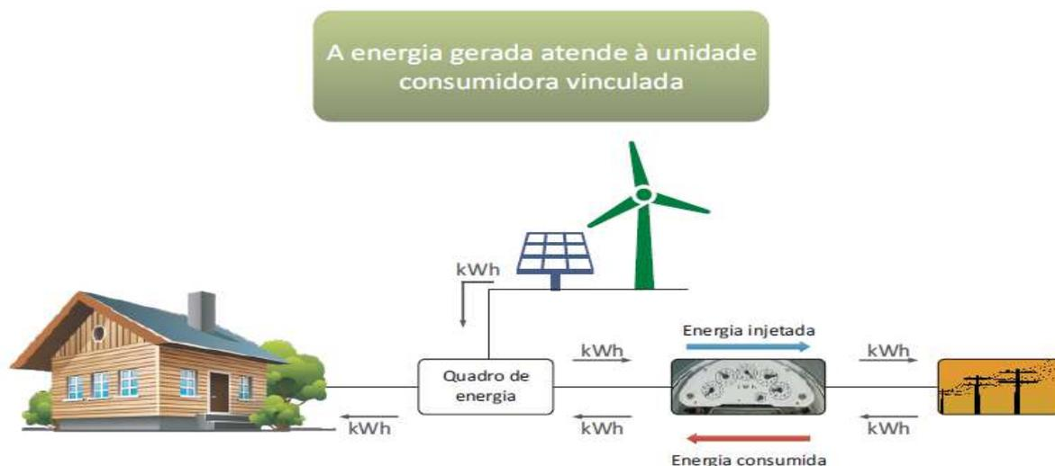
Figura 1 – Sistema de Compensação de Energia
