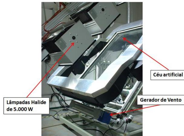
Figura 1 – Simulador solar, vista frontal.
