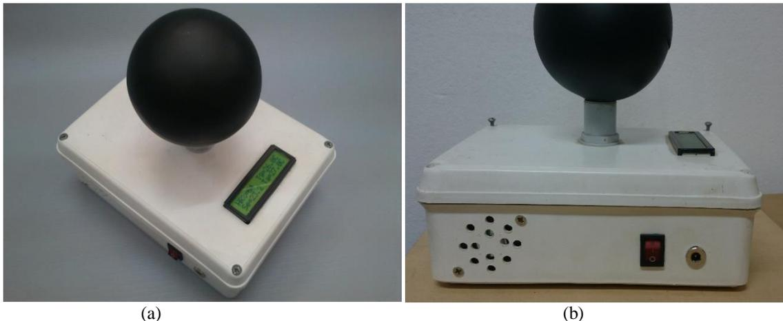
Figura 2 - Fotografía del prototipo desarrollado para la determinación del índice de confort térmico a) Vista superior, b) Detalle del sistema de circulación de aire forzado.
