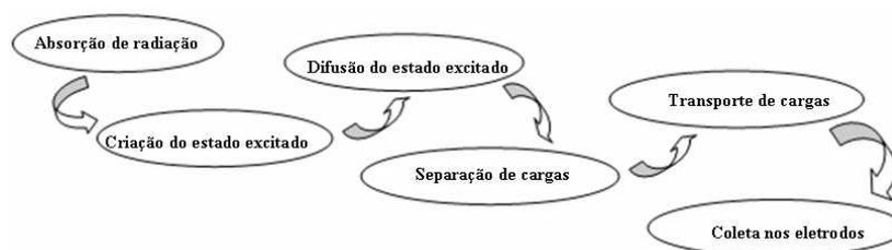
Figura 2- Processos envolvidos na geração de corrente elétrica na célula de Grätzel.
