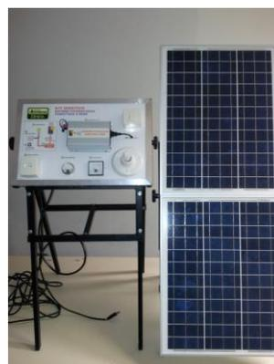
Figura 4 – Kit sistema fotovoltaico conectado à rede
