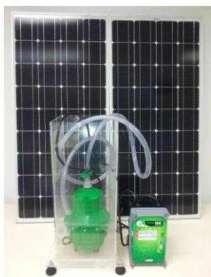
Figura 3 – Kit sistema fotovoltaico isolado
