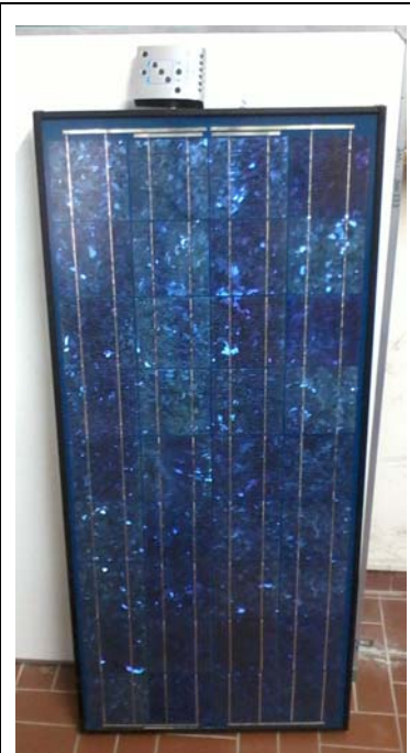
Figura 2. Panel fotovoltaico y regulador de Tensión PWM.
