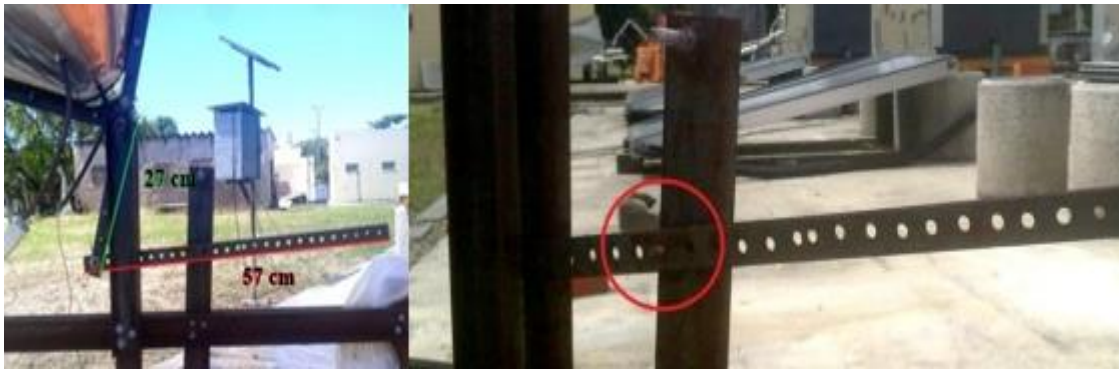
Figura 5: Base metálica com sistema de ajuste dos ângulos do coletor. LESGN.
